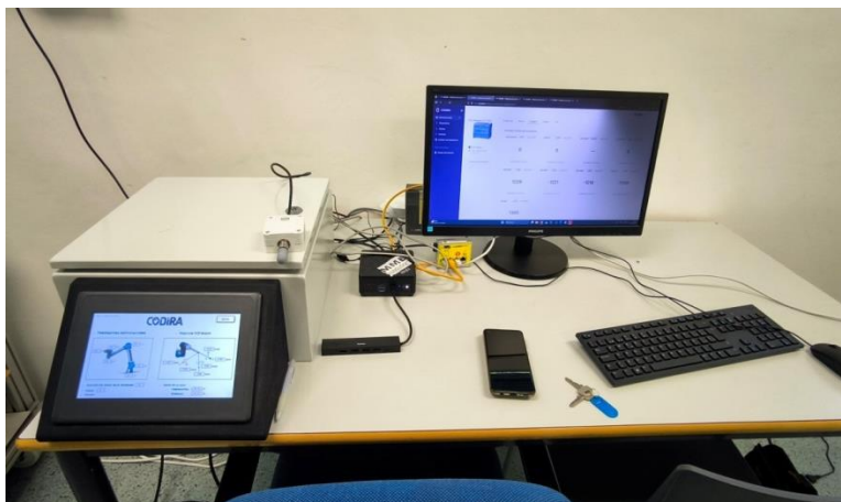
Parte del demostrador de CODIRA (PLC + HMI con sensores. MiniPC donde se ejecuta CODIRA con monitor, y MODEM)
